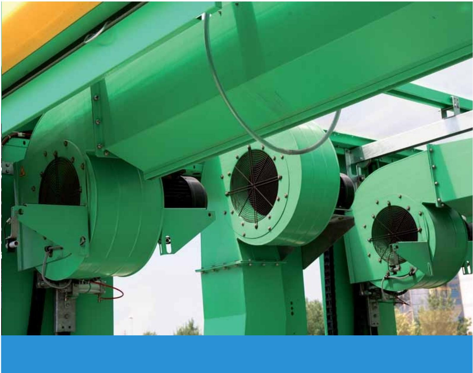
Las toberas horizontales de alta capacidad de los Túneles HERCULES están equipadas con un sistema de giro que permite la inclinación de las mismas para adaptar el caudal de aire perfectamente al perfil de cada vehículo.
